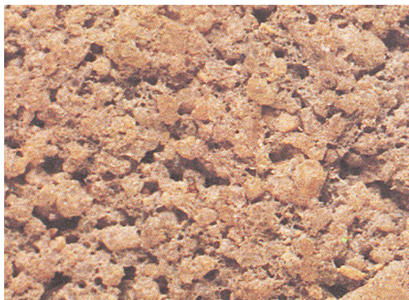
Zdjęcie 3. Tekstura utwardzonej zaprawy cementowej z domieszką napowietrzającą.
